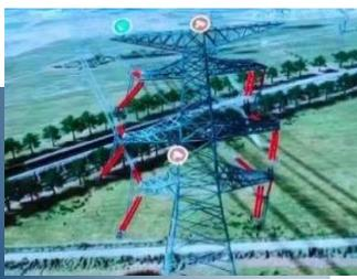
En las áreas urbanas densamente construidas, sin espacio aéreo donde se pueda hacer un sobrevuelo seguro de drones para las inspecciones del tendido de líneas, el personal de inspección puede utilizar el SLAM 100 en mochilas y coleccionar datos de nubes de puntos de las líneas de transmisión para la posterior detección de defectos, actualización del inventario del tendido y visualización en 3D, planificación de trayectorias de UAV y otras aplicaciones.
