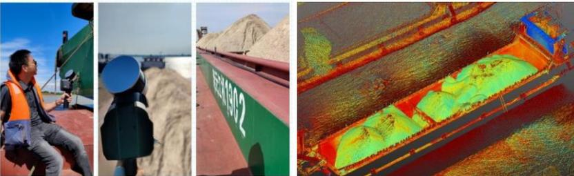
Toma de datos para el cálculo de arena transportada con el SLAM 100
